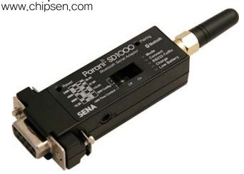
Parani-SD1000 은 Class1 type의 블루투스 시리얼 어댑터입니 다. 기본적으로 100m의 무선 통신거리를 지원합니다. 거리확장용 안테나 사용 시 개방된 공간에서 최대 1000m의 통신거리를 지원합니다. Parani-SD1000은 Bluetooth v2.0+EDR 스펙을 지원합니다. Parani-SD1000은 기본형과 대용량의 2가지 배터리 옵션을 제공합니다. 이 두개의 옵션으로 Parani-SD1000의 이동성은 더욱 강화되었습니다.
