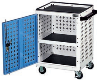
TPU6-3SC-HB(G) SIZE(W × D × H) 600 × 530 × 880 45kg 선반식, 100kg/선반단당하중 4인치 우레탄 바퀴부착, 1도어잠금장치
