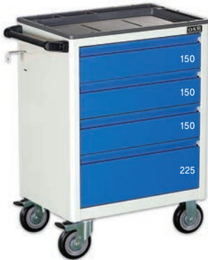
TPU911-4D(G) SIZE(W × D × H) 허용하중 670 × 460 × 950 79kg 400kg 4단서랍식, 100kg/서랍단당하중 서랍내부 분할방식, 5인치 우레탄 바퀴부착 사이드 잠금장치
