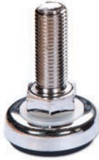
품명 모델 LEVEL BOLT LB-45 방진 및 높낮이 조절용, M16*2.0P 표면처리: 니켈도금 재질: STEEL + NBR 허용하중: 4EA/800kg
