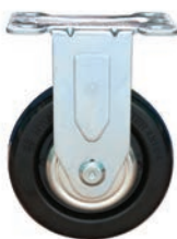
품명 모델 CASTER 4인치(고정) 적용모델: TPU-, TVD-, TBR-, PC- series 허용하중: EA/100kg
