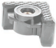
품명 모델 FOOT LEVEL FLT-50 적용모델: TPU-, TCS-, TRS-, TMC- TSD-, TBR- series 재질: ABS + M16 너트 허용하중: 4EA/2400kg
