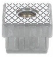
품명 모델 FOOT LEVEL FLS-50 적용모델: TSW-, OMR-, HMR- TBR- series 재질: ABS + M16 너트 허용하중: 4EA/3000kg
