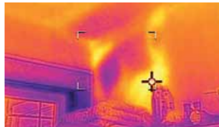
단열 처리가 되지 않은 부분과 건물이 가진 다른 문제들을 온도 변화 패턴을 통해 알아볼 수 있습니다.
