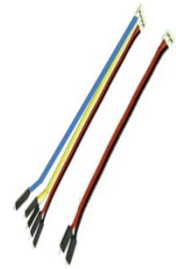
5pin(UART 용) & 2pin(전원용) cable
