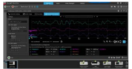
그림 4 : 측정 데이터의 원격 로깅 및 플롯팅을 위해 BenchVue를 이용합니다.
