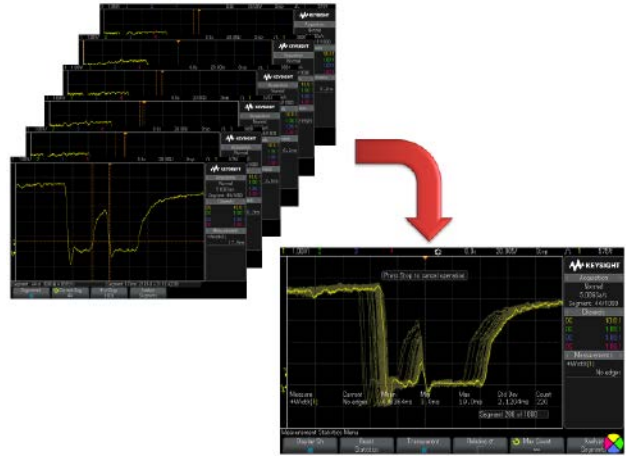
세그먼트 메모리를 사용해서 100초 동안 1,000개의 매우 간헐적인 글리치를 캡처한 다음, 세그먼트 1,000개에 대한 세그먼트 간 측정 및 오버레이 분석을 실행합니다.
