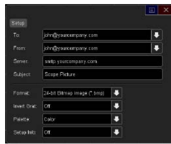
그림 6: LAN/VGA 모듈 옵션을 통해 측정 결과와 셋업, 데이터, 스크린샷을 자신의 이메일로 전송할 수 있습니다.
