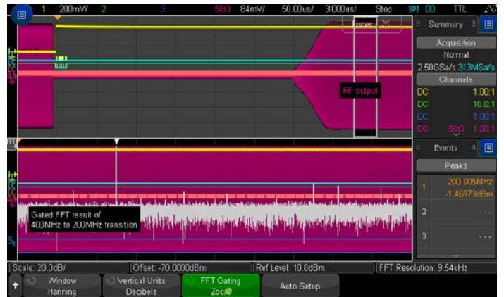
그림 21d: 검색 lister 디스플레이에 표시되어 있듯이 RF 신호는 200 MHz에서 안정적으로 유지됩니다.
