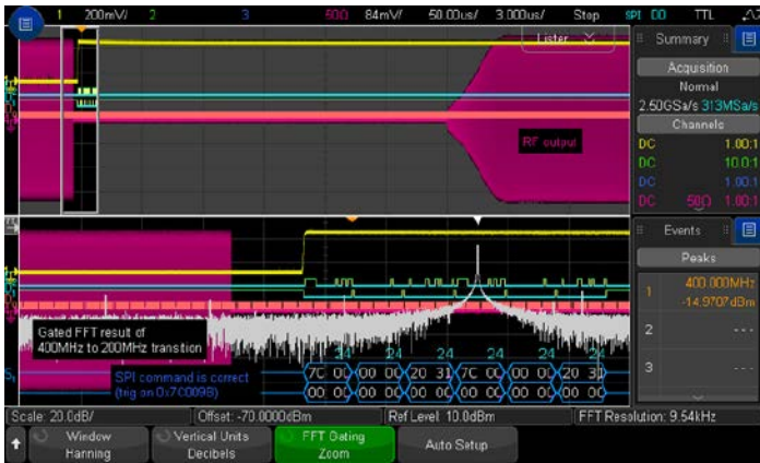
그림 21a: SPI 명령에서 트리거링된 RF 신호는 주파수 피크 검색 결과에 대한 lister 디스플레이에 표시되어 있듯이 여전히 400 MHz에 있습니다.
