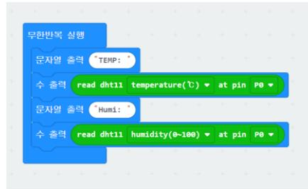
무한 반복 실행 블록으로 온도와 습도가 계속 표시될 수 있게 해줍니다. 출력한 데이터가 온도인지 또는 습도인지 알기 위하여 문자열을 출력하고 난 후에 수 출력을 합니다. 수 출력에서는 모두 핀 P0에서 데이터를 받기에 P0으로 설정해주고, 각각 온도(temperature)과 습도(humidity)를 선택하게 됩니다.
