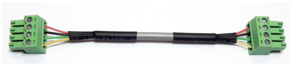
광절연 통신라인 결선 사진
